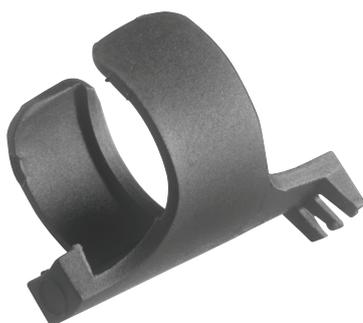
可使用 DCN-DISCLM 缆线夹将电缆固定到 DCN-CCU2 干线输出，以防止它们被意外拉出。
