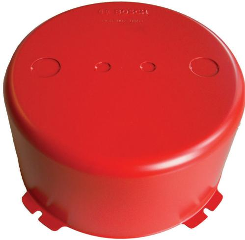
화재시 라우드스피커가 설치된 천장의 구멍은 화염을 건물 전체로 퍼지게 하는 통로가 될 수 있습니다. 이에 대비하여 불길이 라우드스피커를 통해 구멍으로 들어오지 못하도록 천장형 라우드스피커에 소방용 강철 돔을 장착할 수 있습니다. 옵션으로 제공되는 이 소방용 돔은 기본으로 제공되는 4개의 셀프 태핑 스크루를 이용해 라우드스피커 구성품 위에 장착됩니다. 소방용 돔의 녹아웃 홀 중 2개는 패킹(기본 제공)용이며 2개는 케이블 글랜드(PG 13)용입니다. 이 소방용 돔은 LBC 3099/41 천장형 라우드스피커에만 사용할 수 있습니다.
