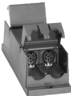
タップオフユニットにより、中継ケーブル上に耐ショートタップオフポイントを設けることができます。各タップオフポイントには、最大 5 台のチャンネルセレクトパネル、またはディスカッションユニット、コンセンタスユニット、通訳者卓などの 1 つのテーブルトップユニットを接続できます。タップオフユニットは、2 つのタップオフポイントで構成されています。タップオフユニットには、ケーブル固定用クランプが付いていて、固定用の穴が開いています。
