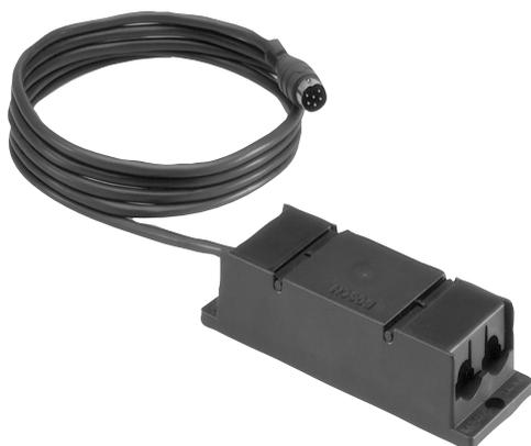
トランクスプリッタは、システムとともに使用して中継ケーブルを分割するために使用します。これにより、中継ケーブルとコントリビューションユニットのレイアウトを会議室に合わせて最適化できます。トランクスプリッタには、ケーブル固定用クランプが付属しており、床または壁面取り付け用の穴が開いています。
