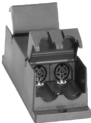
Tap-Off Unit menciptakan titik tap-off yang tahan hubungan pendek pada perkabelan jalur utama. Masing-masing titik tap-off memungkinkan koneksi maksimal lima panel pemilih saluran atau satu unit kontribusi permukaan meja seperti unit Diskusi, unit Concentus, atau Meja Juru Bahasa. Tap-Off Unit terdiri atas dua titik tap-off. Trunk Splitter hadir lengkap dengan klem penahan kabel dan menyertakan lubang pemasangan untuk menyesuaikan dengan tujuannya.
