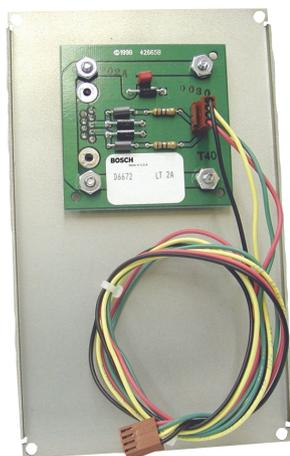
Crée un troisième port série sur le récepteur/passerelle Conettix D6600. Offre un connecteur mâle DB9 et une protection contre les transitoires.
