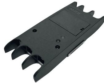
Le dérivateur permet de créer des branches dans le réseau. Les branches sont toujours contrôlées, mais ne disposent pas du câblage redondant du réseau principal. Le dérivateur de bus peut se connecter à une alimentation supplémentaire de 48 Vcc si besoin. Il peut également être utilisé comme répéteur pour allonger le câble en fibre optique plastique de 50 mètres supplémentaires.
