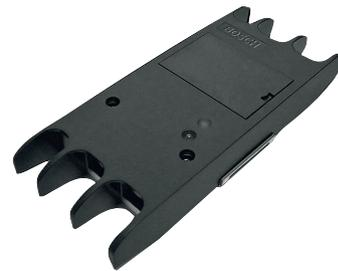
El divisor de red permite dividir la línea de red principal en secciones. Las líneas divisorias se siguen supervisando, aunque no disponen del cableado redundante de la línea principal de la red. El divisor de red tiene una opción para conectar una fuente de alimentación de 48 VCC que puede proporcionar alimentación adicional si es necesario. El divisor de red también puede utilizarse como un repetidor para ampliar el cable 50 metros adicionales con fibra de plástico.
