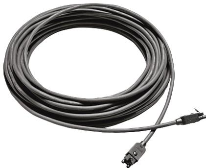
Se trata de un cable especial con 2 fibras plásticas para la comunicación de datos y de audio y 2 hilos de cobre para la fuente de alimentación. El cable se suministra con los conectores. Este cable se puede utilizar para conectar la CCU a los expansores de audio.
