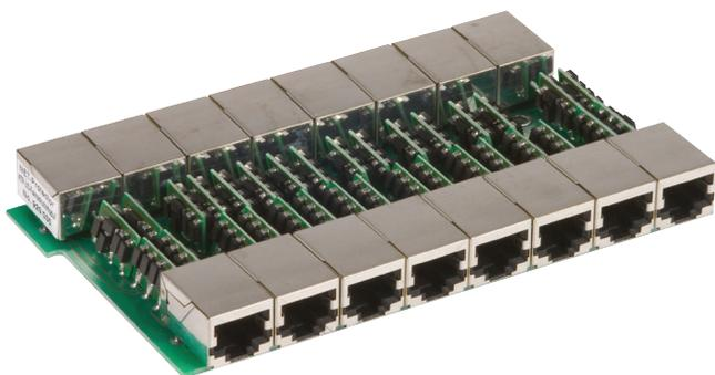
Überspannungsschutz-Platine der Ableiterklasse Type 4 / P1 zum Einbau in NET-Protector-19 Zoll-Einbaugeschütz, zum Einsatz in Cat. 5-Datennetzen nach EN 50 173 für den Schutz von 8 Ports aktiver Geräte im Etagenverteiler, geprüft nach EN 61643-21.
