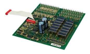
Zur Erweiterung für die AT 2000 Übertragungsgeräte von Ein- und Ausgängen mit 12 Meldeleitungen (Gleichstrom-Primärleitungen) und 12 Ausgängen (Relaiskontakte).
