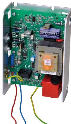
Das Netzteil NT 7400 dient zur Spannungsversorgung von z.B. Übertragungseinrichtungen, in deren Gehäuse ein entsprechender Einbauplatz vorgesehen ist.
