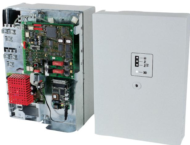
Der ATE IP ISDN ist ein Alarm Receiver mit Alarmempfang über das IP-Netz und ISDN-Netz.
