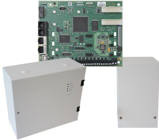
Die Alarmübertragungseinrichtung der AT 6200 Familie dienen zur Übermittlung von Gefahrenmeldungen (Einbruch, Überfall, Brand usw.) und technischen Alarmen (Betriebszustände, Grenzwerte, Störungen).
