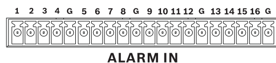
Figura 4.9 Conector de entrada de alarma para modelos de 16 canales
