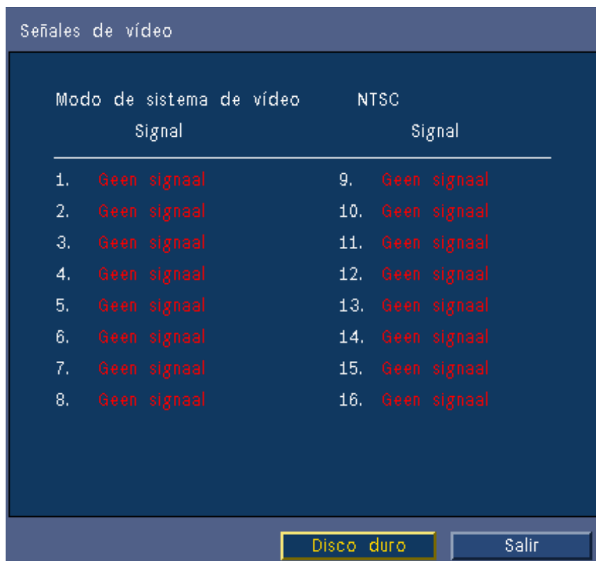
Figura 5.11 Barra de control del sistema: Información de señales de vídeo En el menú de información del vídeo se muestra el sistema de vídeo que se ha configurado y las entradas en las que se han detectado las señales de vídeo.
