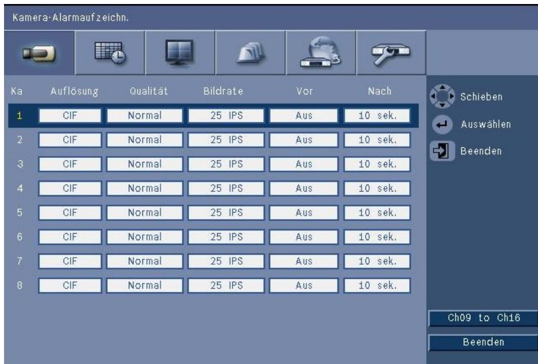
Bild 6.6 Kamera – Aufnahme bei Sensoralarm
