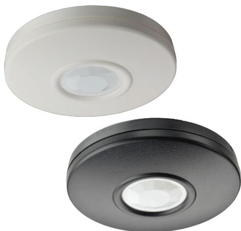
Le détecteur IRP panoramique compact DS936 à monter au plafond utilise un compte d'impulsions de polarité alternée. Il utilise également un objectif orientable Fresnel, pour une couverture pouvant atteindre 7,5 m, et peut être monté en surface ou semi-encastré, directement sur un plafond, ou sur un coffret de branchement octogonal standard.
