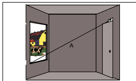
Рис. 3.1. Установка на противоположную стену с использованием дверного контакта
