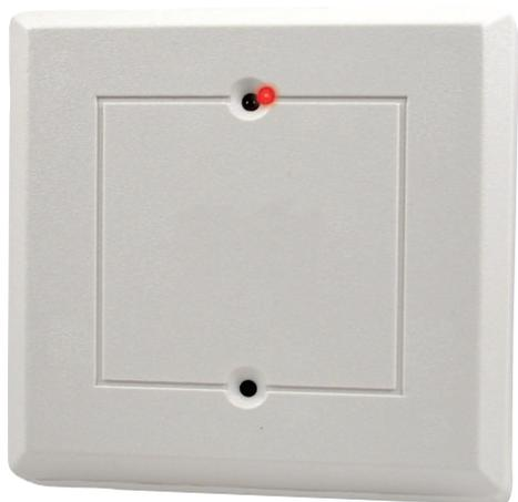
DS1102i探测器系列采用基于微处理器的声音分析技术(SAT)来监听与玻璃破碎相关的特定频率。DS1102i和DS1102i-CHI可以用来探测普通玻璃、钢化玻璃、夹层玻璃和夹丝玻璃的破碎声音。在嘈杂的环境中，内置环境测试功能可以提醒安装人员存在误报风险。方形探测器安装在天花板或墙壁上。
