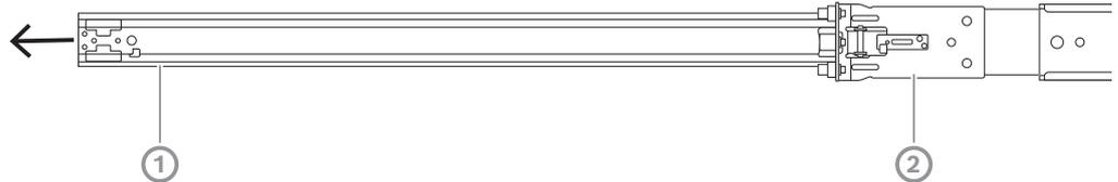
2. Ziehen Sie die Innenschiene (1) aus der Mittelschiene (3), bis sie hörbar einrastet. Schieben Sie die weiße Entriegelung (2) nach außen und nehmen Sie die Innenschiene (1) vollständig aus der Mittelschiene (3).
