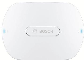
Беспроводная точка доступа (DCNM-WAP) является центральным устройством беспроводной конференц-системы DICENTIS. Она связывает беспроводные устройства (DCNM-WD и DCNM-WDE) с помощью защищенного беспроводного соединения WPA2. Компактное устройство DCNM-WAP со встроенным интерфейсом через веб-браузер – это все, что необходимо для установки, настройки и управления беспроводной конференц-системой DICENTIS.
