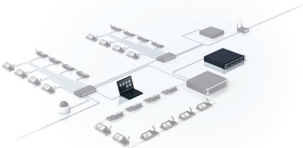
Le module logiciel de contrôle des caméras DICENTIS permet de relier le système de conférence DICENTIS et le système radio DICENTIS aux caméras IP. Il sélectionne l'activation des caméras fixes ou des caméras dont la position est fixée à l'avance, afin d'afficher l'orateur actuel lors d'une réunion.
