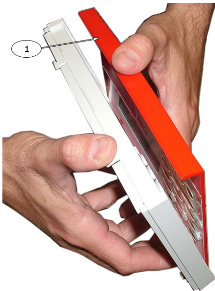
Figure 5: Soulèvement du couvercle rouge
