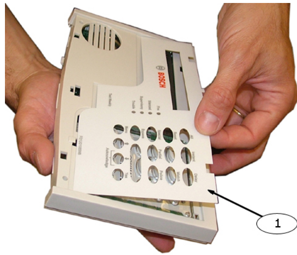
Figure 7: Retrait de la plaque avant
