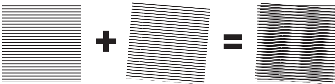
Rysunek 4.1: Efekt Moiré'a wywołany dwoma nakładającymi się schematami (przykład)
