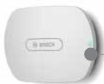
スタンドアロン形式の設置簡単なワイヤレスアクセスポイント (WAP)。完全なワイヤレス接続、ブラウザインターフェイス内蔵。自動HDカメラコントロールのサポート。
