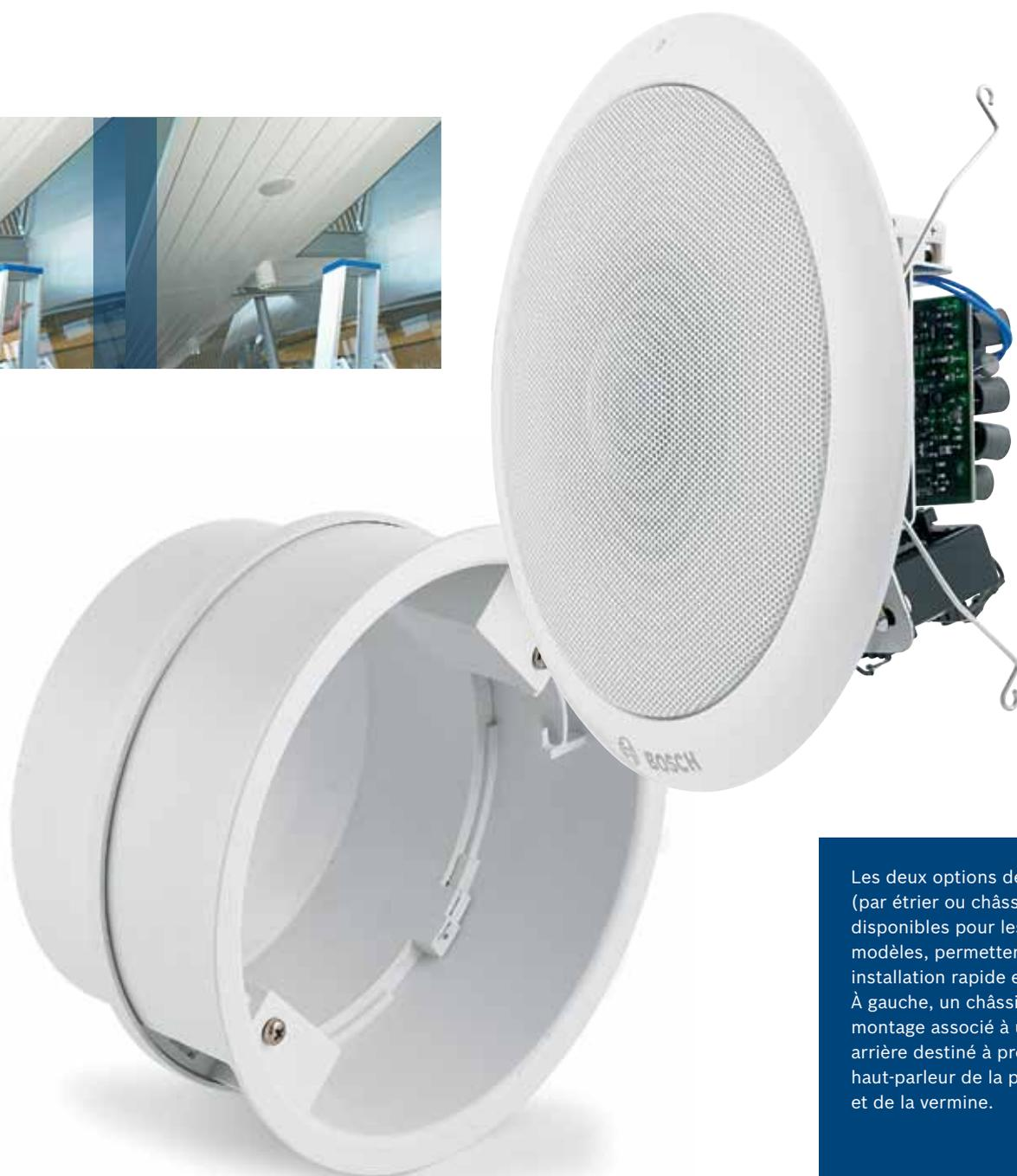
Les deux options de montage (par étrier ou châssis), disponibles pour les quatre modèles, permettent une installation rapide et aisée. À gauche, un châssis de montage associé à un boîtier arrière destiné à protéger le haut-parleur de la poussière et de la vermine.
