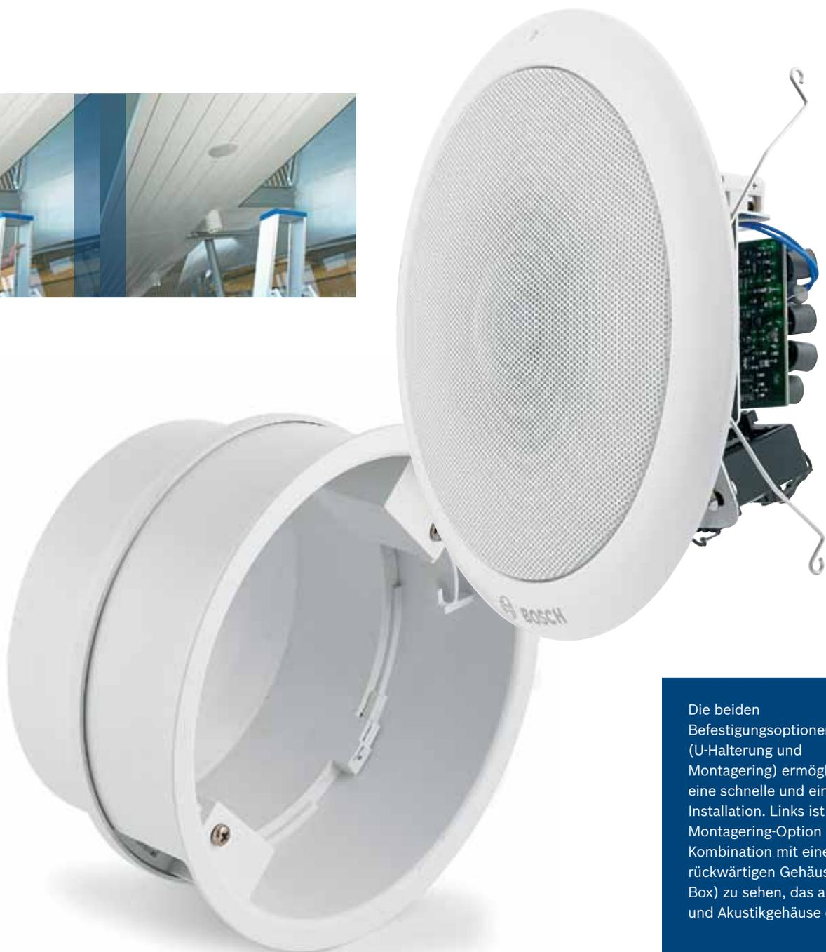
Die beiden Befestigungsoptionen (U-Halterung und Montagering) ermöglichen eine schnelle und einfache Installation. Links ist die Montagering-Option in Kombination mit einem rückwärtigen Gehäuse (Back Box) zu sehen, das als Schutz- und Akustikgehäuse dient.
