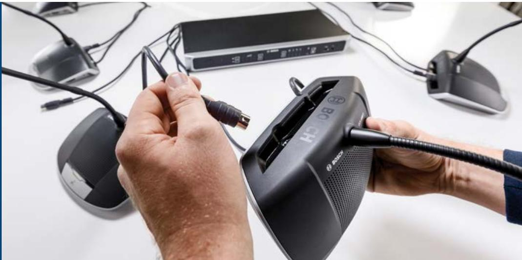
Sistem ini sangat cepat dan mudah diinstal. Tidak memerlukan pelatihan dan peralatan tambahan: perangkat diskusi secara langsung dipasang ke unit kontrol melalui sambungan kabel 'daisy-chain' yang mudah.
