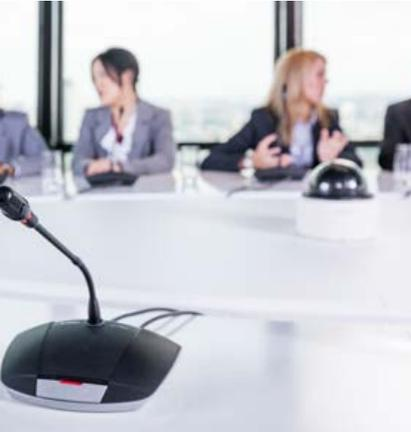
Konfigurasi canggih dan kontrol rapat dapat dilakukan melalui tablet dan browser web internal sistem. Selain itu, semua orang akan tahu siapa yang sedang berbicara, berkat dukungan terpasang sistem untuk kontrol kamera otomatis.
