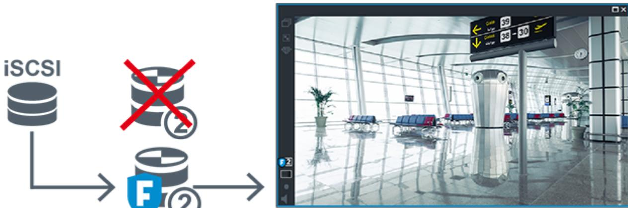
如果未连接辅助 VRM 和可选的辅助故障转移 VRM，则编码器将提供回放。关闭图像窗格，并将摄像机再次拖动至图像窗格：
