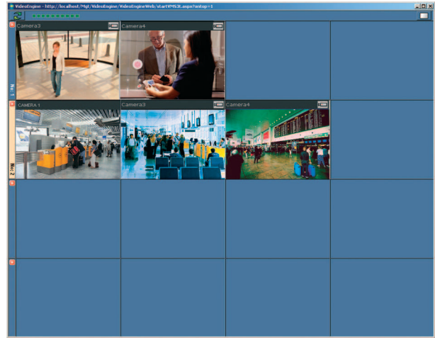
Şek. 1: 2 etkin alarm durumuna sahip bir alarm matrisi örneği
