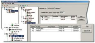
Diese Funktion ermöglicht die Definition und Verwendung des Türmodells "Parkplatz", das die Steuerung von zwei Schranken für die Ein- und Ausfahrt sowie deren Ampeln enthält, über die der Zutritt verhindert wird, wenn der Parkplatz seine maximale Kapazität erreicht hat.
