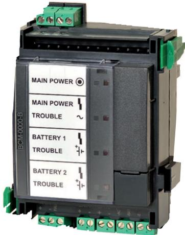
Das BCM-0000-B Batterieregler-Modul überwacht die Spannungsversorgung der gesamten Zentrale und regelt temperatur- und zeitgesteuert das Laden von bis zu vier Batterien (12 V/24 Ah bis 12 V/26 Ah oder 12 V/36 Ah bis 12 V/45 Ah).
