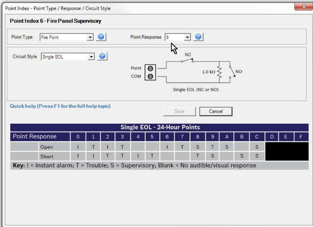
Figura 2.3: Respuesta de tipo de punto y estilo de circuito
