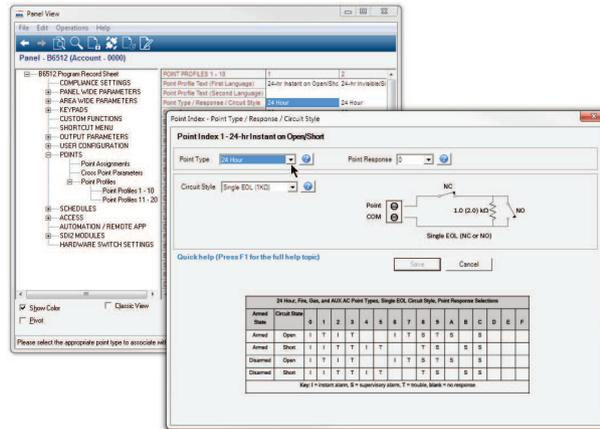
Juntos, los parámetros Respuesta de punto y Tipo de punto determinan la respuesta del panel de control a los cambios en los bucles de sensores de los puntos (abierto, cortocircuito, normal) para los puntos cableados o a los cambios en los estados de punto de los dispositivos de los puntos inalámbricos (fallo, normal, problema).
