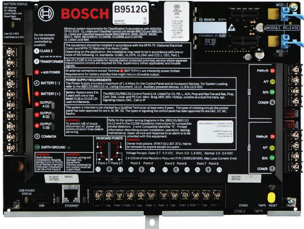
B9512G-CHI报警主机和B8512G-CHI报警主机是Bosch新开发的顶级商业报警主机。B9512G-CHI报警主机集成了入侵和门禁控制，从而为这两个系统提供了一个简单的用户界面。
