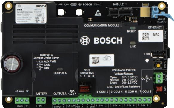
B3512-CHI 报警主机为入侵系统提供一个简单的用户界面。B3512-CHI 在一个分区内提供多达 16 个单独识别的分区。报警主机可通过其内置的 Ethernet 端口、通过能够经由公共交换电话网络 (PSTN) 或蜂窝网络通信发送事件的兼容插入式模块进行通信。
