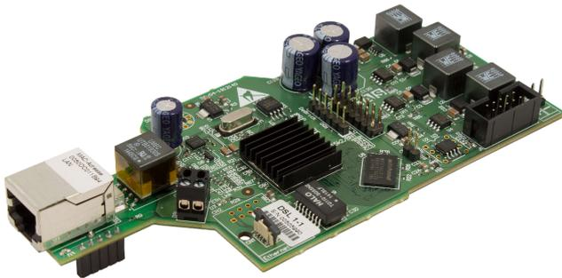
Die AT Erweiterung 5000 DSL Modem erweitert das AT Gerät 5000 um ein DSL Modem.
