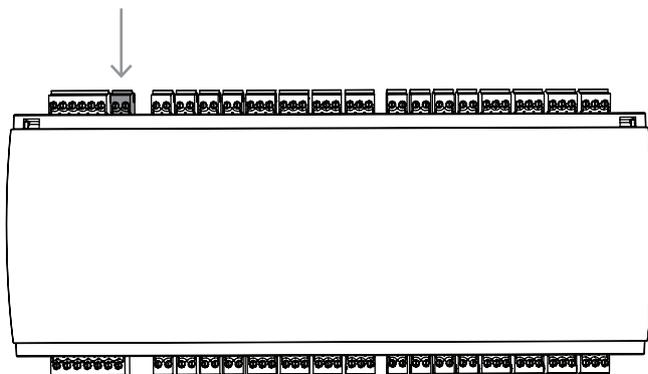
**Figura 4.18:** Posizione del contatto di protezione antimanomissione
