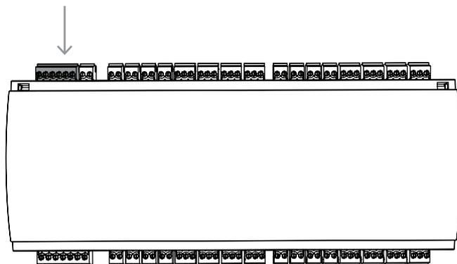
**Figura 4.9:** Posizione del modulo di estensione bus RS-485
