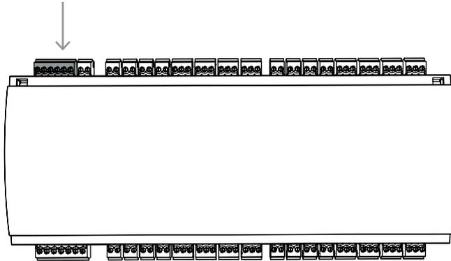
Figura 4.7: Interfaccia per alimentazione interna
