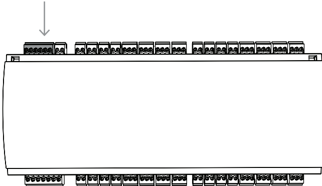
Figura 4.7: Interfaz para fuente de alimentación interna
