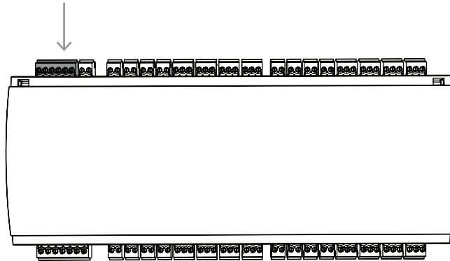
Figura 4.9: Ubicación del bus del módulo de ampliación RS-485
