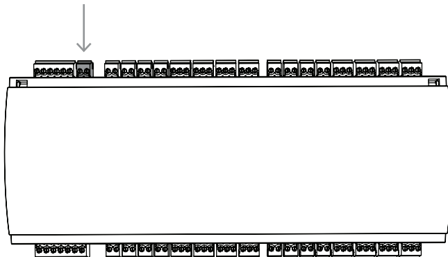
Figura 4.18: Ubicación del contacto de protección antisabotaje
