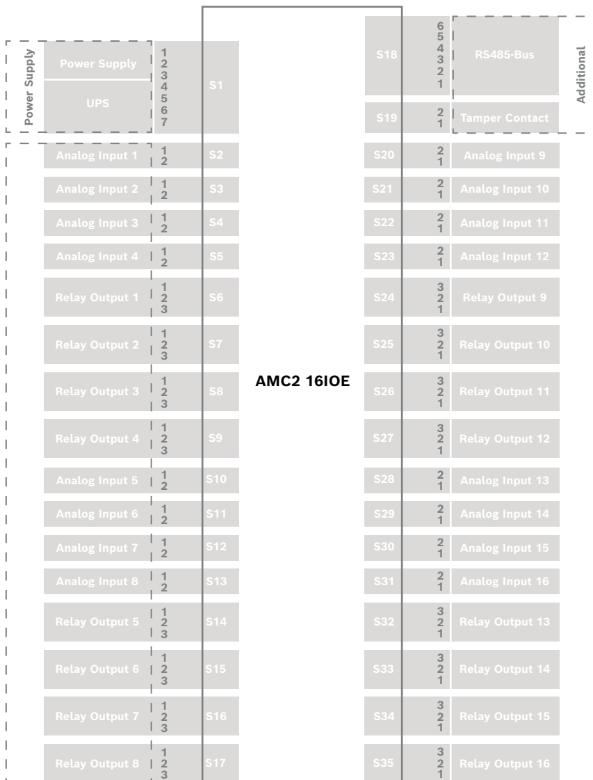
Figura 10.1: Bloques de conectores del AMC2-16IOE
