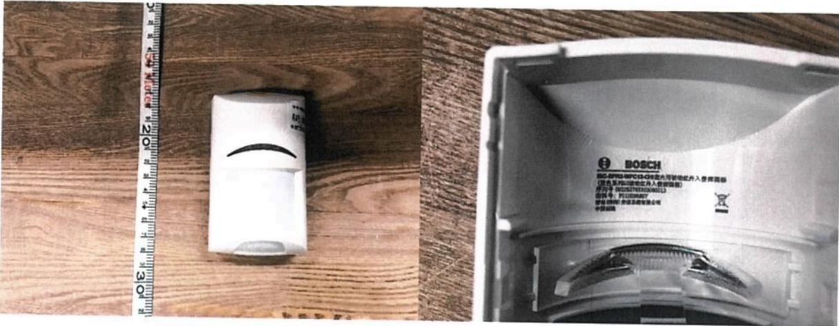
图一: ISC-BPR2-WPC12-CHI 型室内用被动红外入侵探测器 (蓝色系列 G2 被动红外入侵探测器) 外观结构、标识
